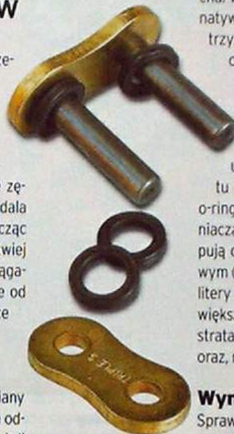
Typowa zapinka łańcucha x-ringowego. Zwróćcie uwagę na charakterystyczny kształt uszczelniaczy
